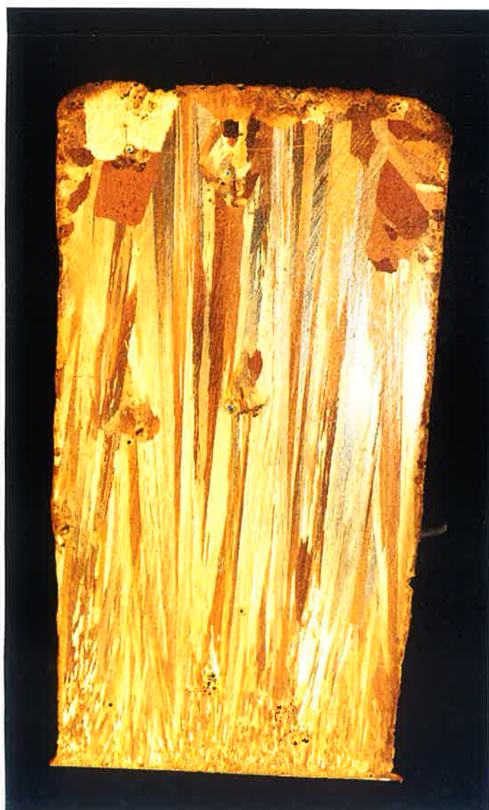
Figura 4.25- Macroestrutura da seção longitudinal da amostra cilíndrica obtida na condição RCol-SemInoc . Reagente: 500ml Etanol, 25g FeCl 3 , 15ml HCl. Aumento: 2,0X.
