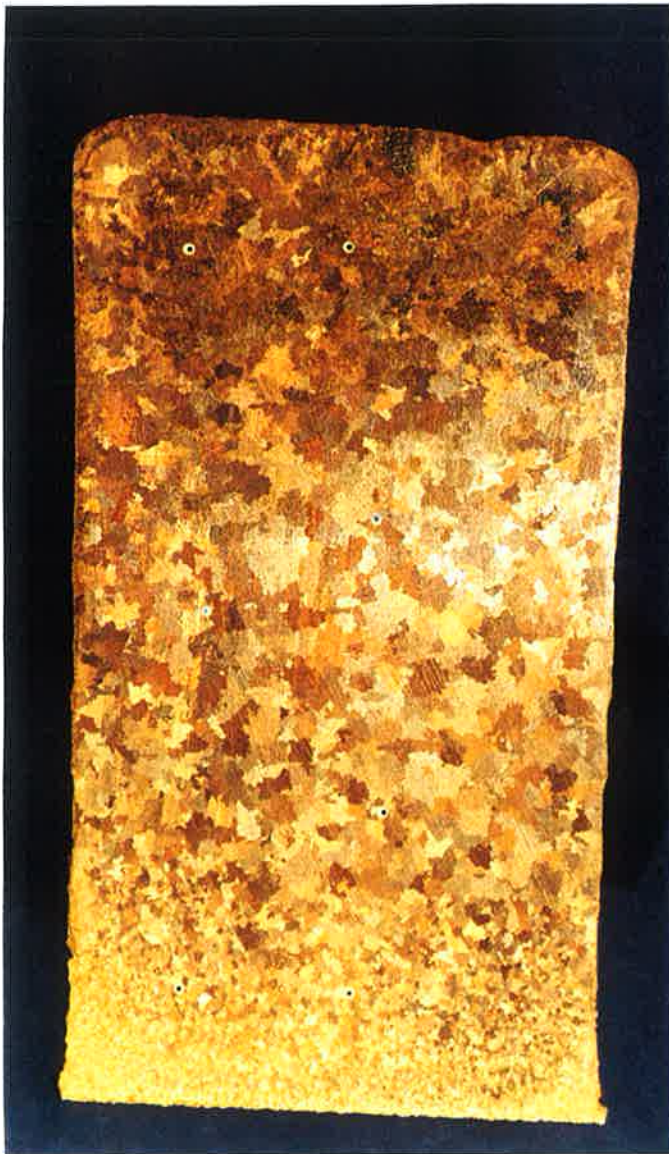
Figura 4.23- Macroestrutura da seção longitudinal das amostras cilíndricas obtidas nas condições: (a) Eq-Inoc e (b) Eq-SemInoc. Reagente: 500ml Etanol, 25g FeCl 3 , 15ml HCl. Aumento: 2,0X.
