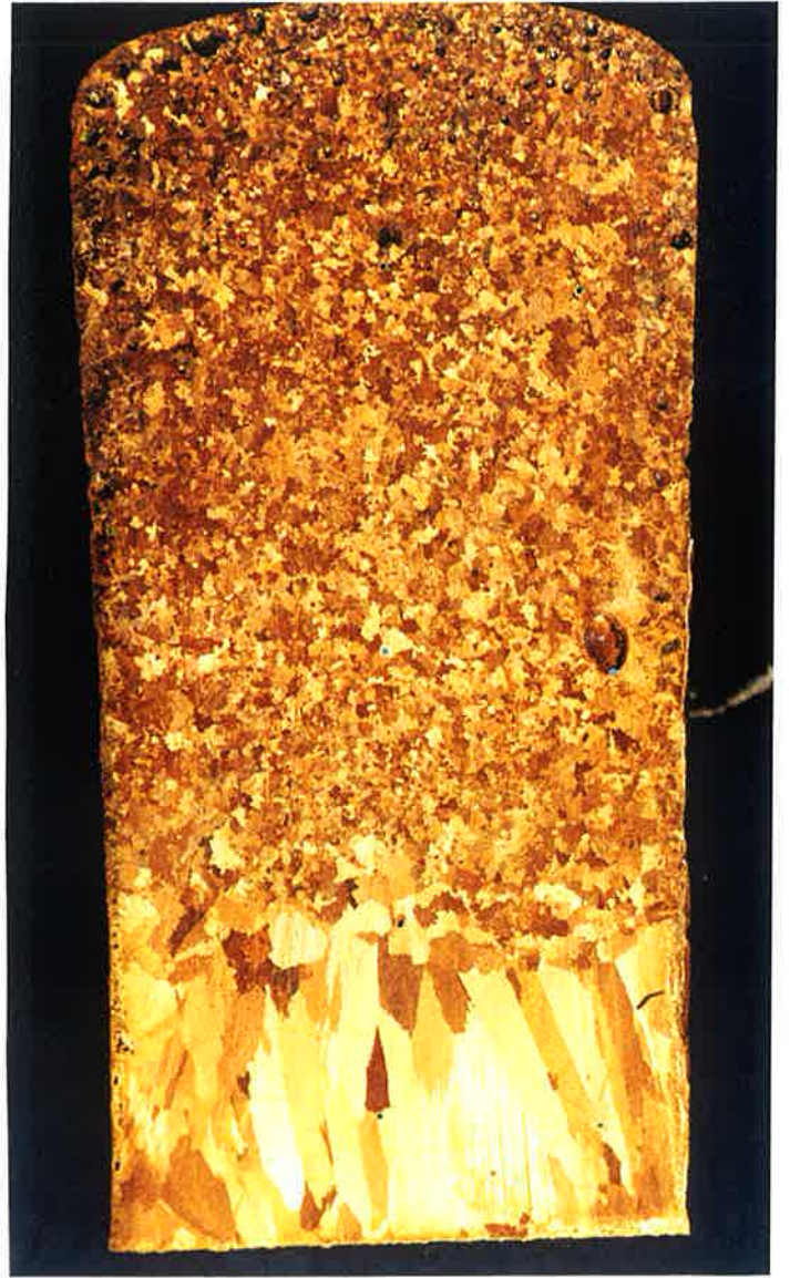
Figura 4.23- Macroestrutura da seção longitudinal das amostras cilíndricas obtidas nas condições: (a) Eq-Inoc e (b) Eq-SemInoc. Reagente: 500ml Etanol, 25g FeCl 3 , 15ml HCl. Aumento: 2,0X.
