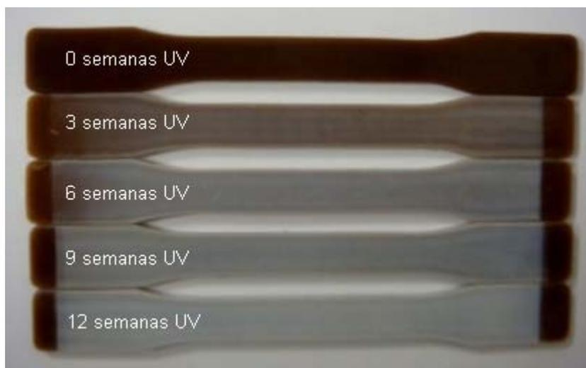
Figura 27 - Embranquecimento do PHB com a fotodegradação
