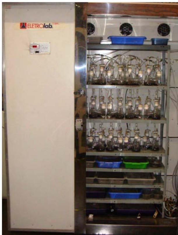
Figura 37 - Bandejas do ensaio de perda de massa e respirômetros de Bartha no interior da estufa
