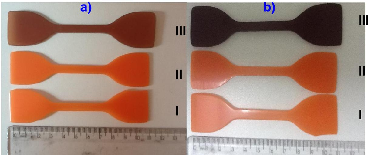
**Figura 28:** Corpos de prova de PU Poliéster não imerso em etanol (I), após imersão em etanol à temperatura ambiente (II) e após imersão em etanol à 60°C (III). a) álcool P.A. b) álcool combustível.
