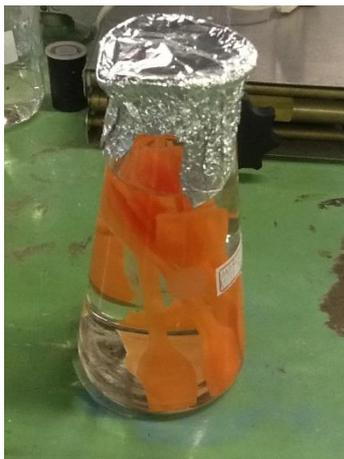
**Figura 18:** Fotografia das amostras de PU Poliéster em contato com etanol.
