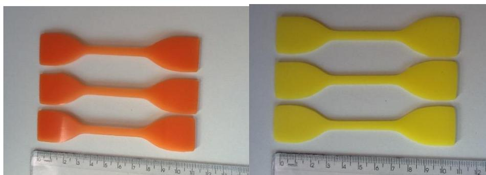
**Figura 10:** Fotografia das amostras de PU poliéster de cor laranja e cor amarela utilizadas neste trabalho.
