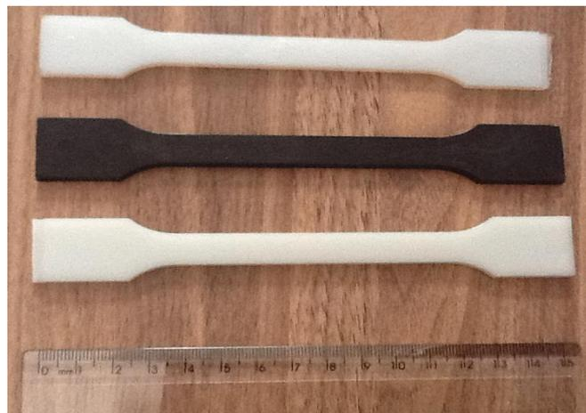
**Figura 24:** Fotografia de corpos de prova de resina polimérica conformados de acordo com a norma ASTM D638 - tipo I.
