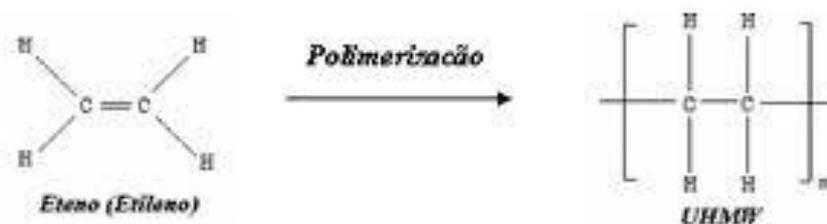
**Figura 16:** Produção do UHMWPE por meio do processo de polimerização do gás etileno.
