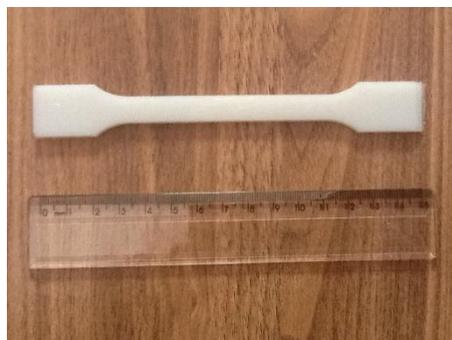
**Figura 14:** Fotografia de uma amostra de Poliamida 6.6 Radilon HSLW utilizada neste trabalho.
