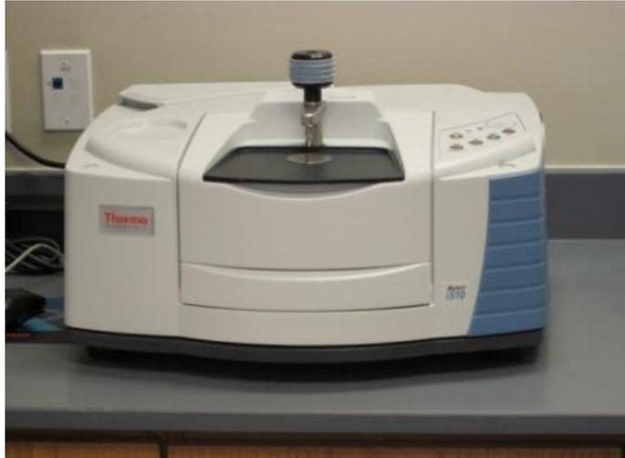
**Figura 26:** Equipamento de análise de infravermelho com acessório de refletância atenuada total (ATR-FTIR).
