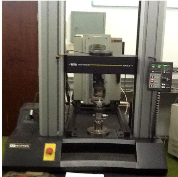
**Figura 21:** Equipamento de ensaio de tração INSTRON 5567.
