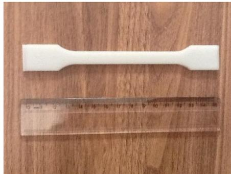
**Figura 13:** Fotografia de uma amostra de Poliamida 6.6 Radilon RV300 utilizada neste trabalho.
