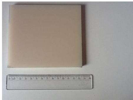
**Figura 17:** Fotografia de uma amostra de ECTFE utilizado neste trabalho.
