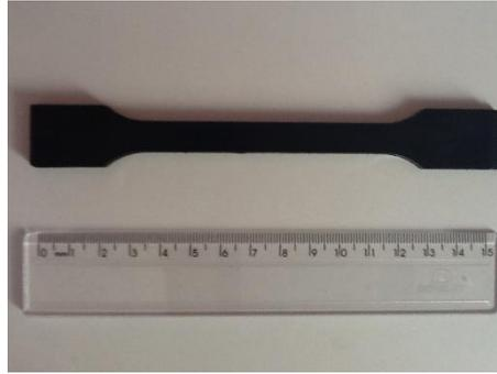
**Figura 12:** Fotografia de uma amostra de Poliamida 66 HERAMID utilizada neste trabalho.
