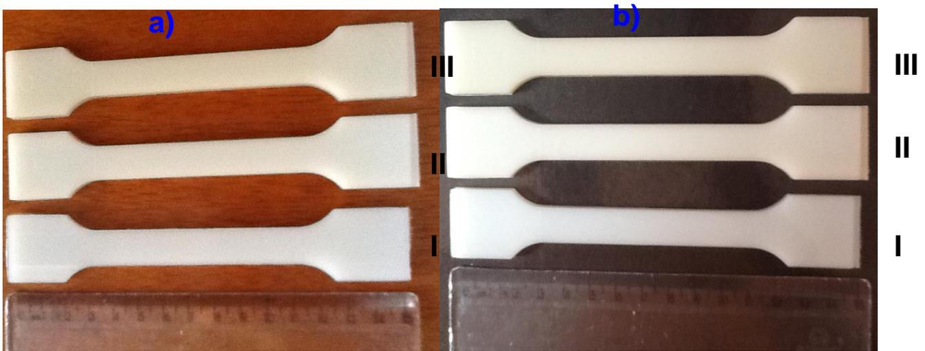
**Figura 31:** Corpos de prova de PA 6.6 Radilon RV 300 não imerso em etanol (I), após imersão em etanol à temperatura ambiente (II) e após imersão em etanol à 60°C (III) a) etanol P.A. b) etanol combustível.
