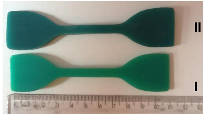
**Figura 27:** Corpo de prova de PU Poliéter não imerso em etanol (I) e corpo de prova do mesmo material após imersão em etanol P.A. à temperatura ambiente (II).
