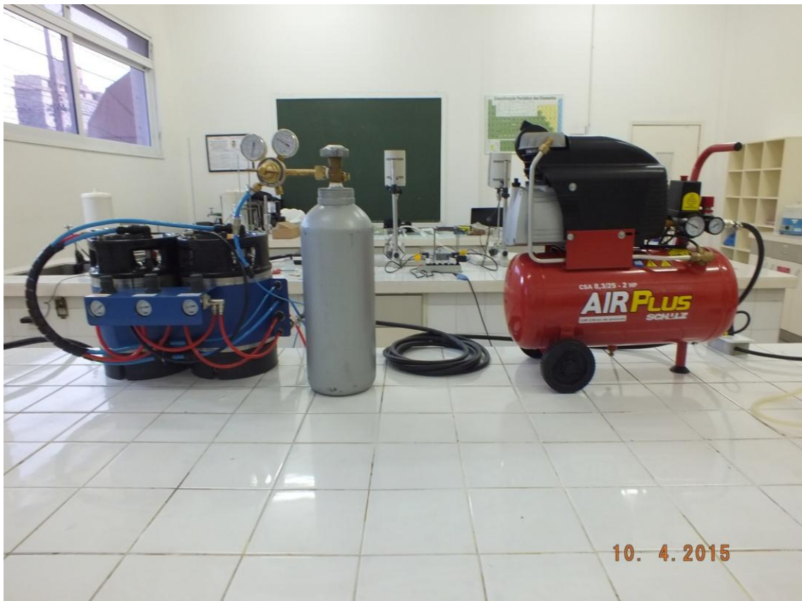
Ilustração 25 - Montagem do sistema completo de aplicação do adesivo base aquosa catalisado com CO 2
