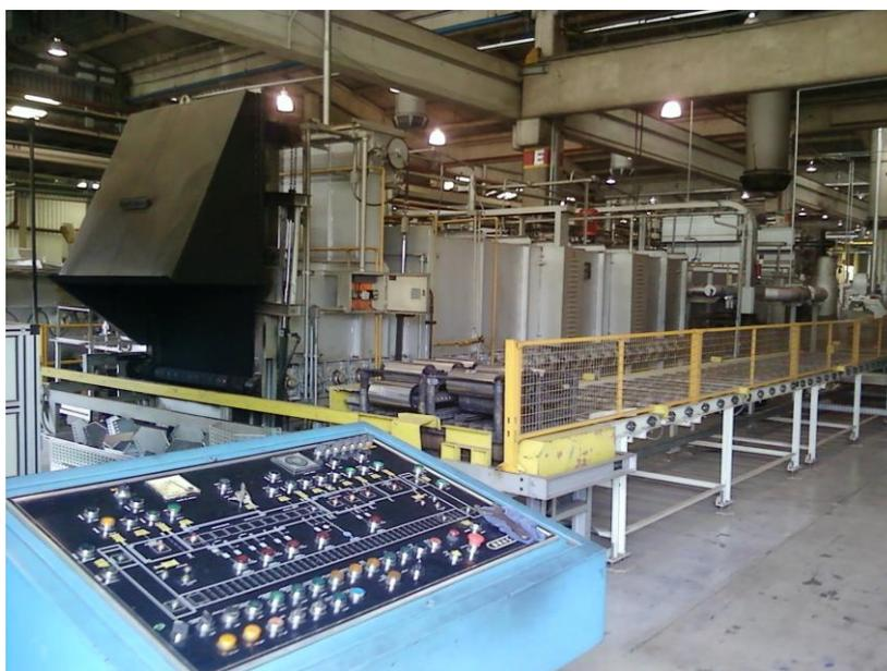
Figura 24 – Forno de recozimento contínuo utilizado para efetuar recozimento
