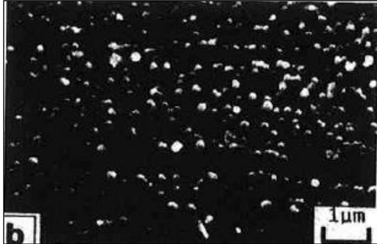
Figura 13 – Óxidos na forma não comum de bandas paralelas a superfície observado em MEV. <sup>(19)</sup>
