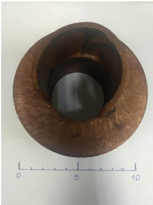
Figura 23: Tubo fundido e tubo laminado para evidenciar a redução de espessura, a escala na figura está em centímetros
