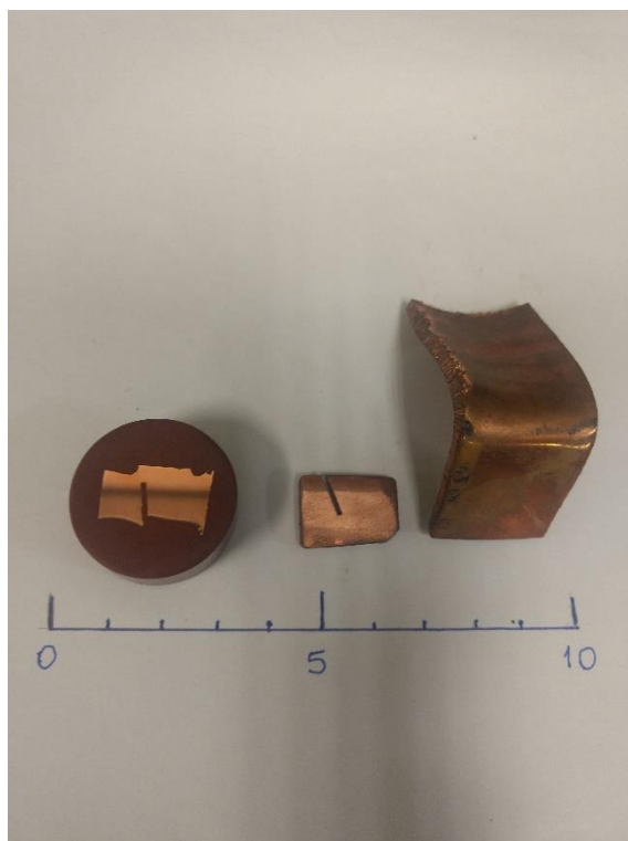
Figura 29: Amostras do tubo fundido e laminado com corte na direção da marca helicoidal, escala em centímetros
