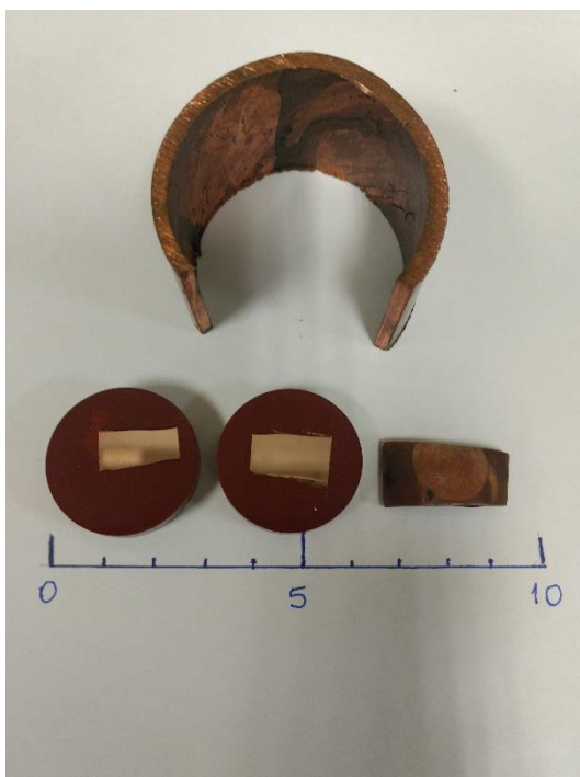
Figura 28: Amostras do tubo extrudado e laminado da superfície externa e da utilizada para macrotextura. Escala em centímetros
