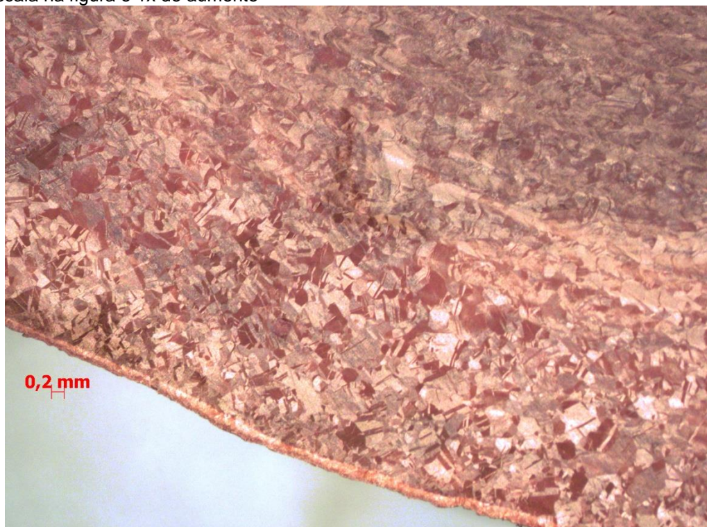
Figura 25: Macrografia do tubo extrudado da superfície transversal com ataque de ácido nítrico 31,25 %, escala na figura e 1x de aumento
