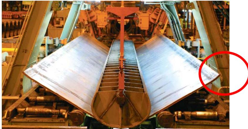
Figura 13 – Conformação da chapa no formato “U”. Detalhe: Bordas prensadas no sentido da curvatura do tubo. Figura baseada na ref. [42].
