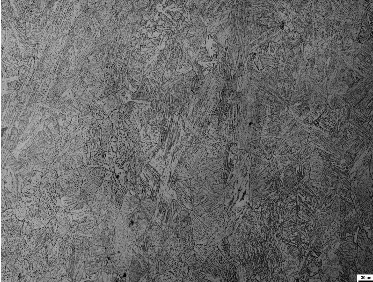
Figura 74– Montagem da microestrutura do metal de solda do passe de enchimento do tubo 1. Ataque: Nital 2%.
