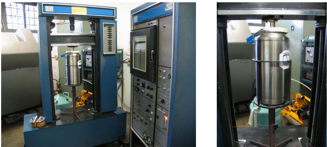
Figura 3.4 - Máquina universal de ensaios mecânicos INSTRON utilizada nos ensaios a -196°C.
