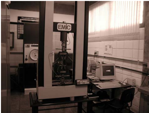
Figura 3.1 - Máquina universal de tração EMIC utilizada nos ensaios a 25°C.
