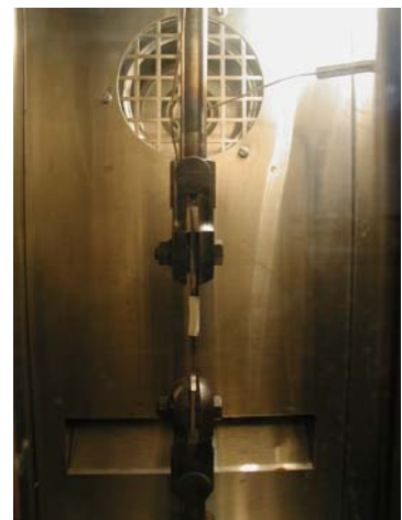
Figura 3.2 - Máquina universal de tração EMIC utilizada nos ensaios a 200°C.
