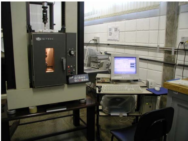
Figura 3.2 - Máquina universal de tração EMIC utilizada nos ensaios a 200°C.
