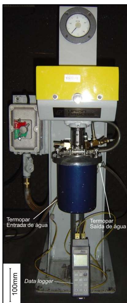
Figura 3.4 Moinho Attritor, marca Union Process, modelo 01HD, destacando o sistema de monitoramento da temperatura do jarro.
