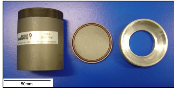
Figura 3.2 Jarro e tampa utilizados com o moinho Spex.
