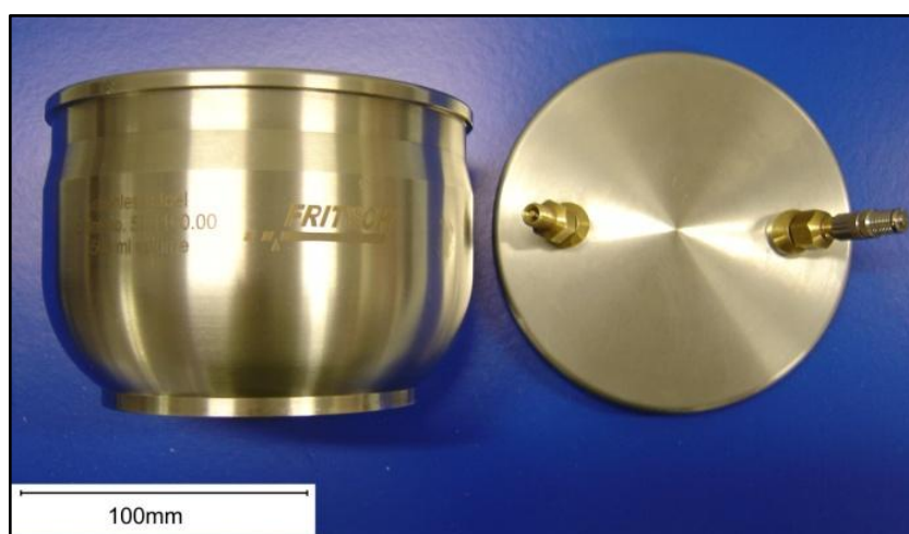
Figura 3.9 Jarro de moagem e tampa utilizados no moinho planetário.
