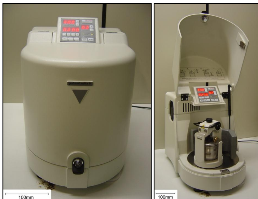
Figura 3.8 Moinho planetário, marca Fritsch, modelo pulverisette 6 ( mono Mill ).
