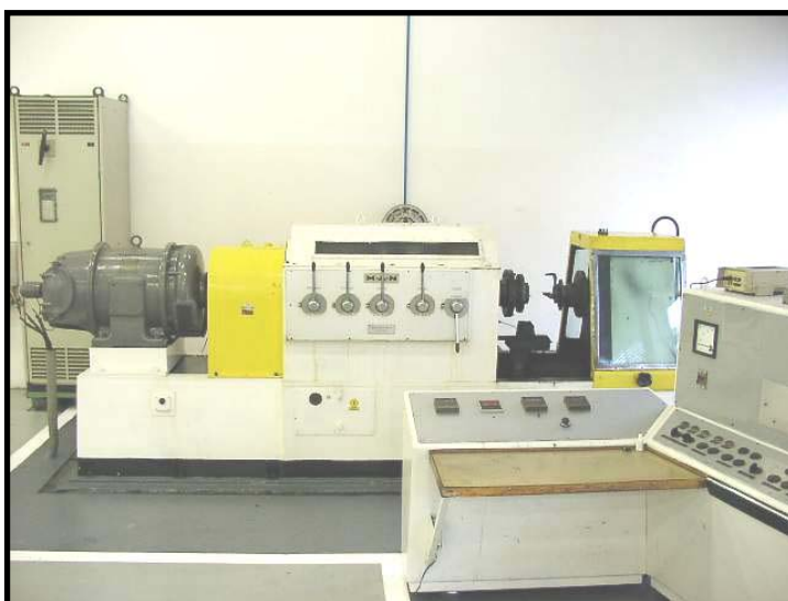
Fig. 3-3 Dinamômetro de massas inerciais variáveis. Localizado no laboratório de durabilidade da VW do Brasil.
