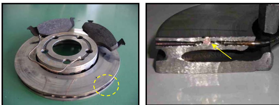
Fig. 3-4 Corpos de prova, instrumentado com termoelemento, após amaciamento inicial. À direita, seção transversal da amostra, onde a seta indica o ponto exato de leitura da temperatura.
