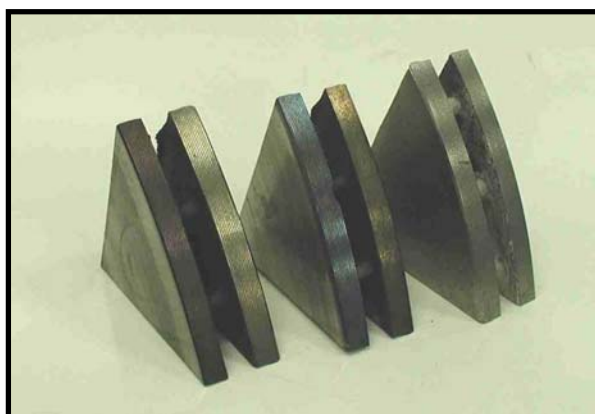
Fig. 4-5 Alteração de cores após ensaio de desgaste.
