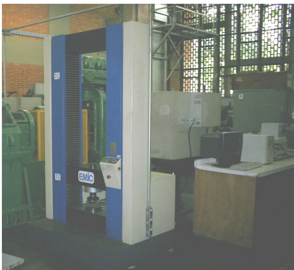
Figura 4.3. Prensa EMIC, de 30 toneladas, utilizada no teste de resistência a compressão a frio das pelotas autorredutoras.
