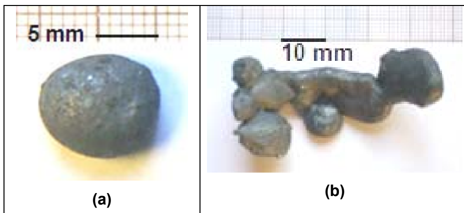
Figura 5.34. (a) nódulo de ferro-carbono obtido a partir da mistura autorredutora de 81% de minério hematítico de baixo teor, 19% de coque de petróleo, +5% de cal processado a 1673 K (1400°C). (b) Nódulos de ferro-carbono obtidos a partir de uma mistura autorredutora de 81% de minério hematítico de baixo teor, 19% de coque de petróleo, +5% de cal +2% de fluorita processada a 1673 K(1400 °C).
