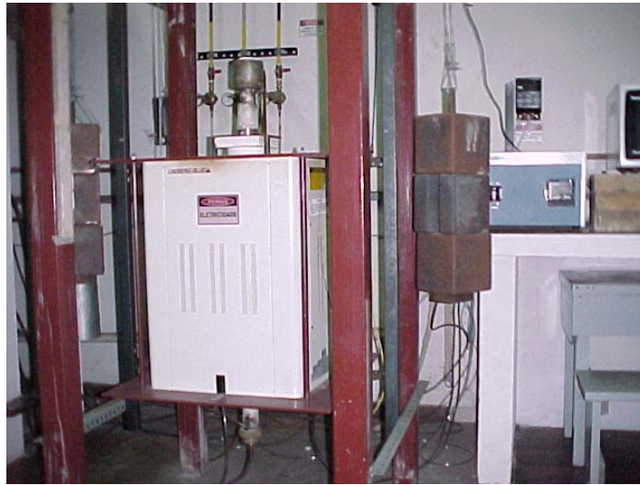
Figura 4.8. Forno Vertical Lindberg/Blue adaptado para ensaios termogravimétricos.
