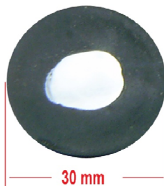
Figura 5.21. Corte transversal de Nódulo de ferro-carbono fixado em baquelita obtido a partir da mistura de 81% de minério hematítico de baixo teor, 19% de coque de petróleo, +5% de cal +50% de recarga processada a 1773 K (1500°C) mostrando ausência de porosidade.
