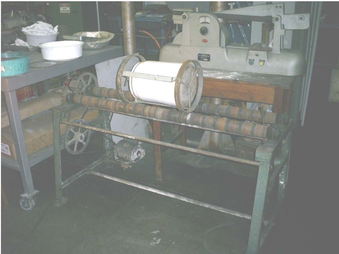
Figura 4.14. Montagem para a realização do teste do tambor.
