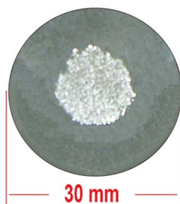
Figura 5.29. Corte transversal de uma pelota de 70% de minério hematítico de alto teor, 30% de grafita, +10% ARI processada a 1773 K (1500°C).
