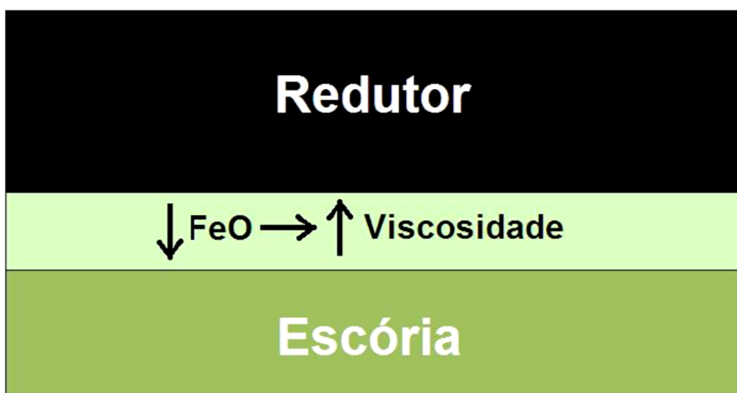
Figura 5.49. Aumento da viscosidade da escória pela diminuição do FeO na interface escória-redutor.
