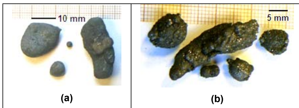
Figura 5.20. (a) Nódulos de ferro-carbono obtidos a partir da mistura autorredutora de 81% de minério hematítico de baixo teor, 19% de coque de petróleo, +5% de cal, processada a 1773 K (1500°C). (b) Nódulos de ferro-carbono obtidos a partir da mistura de 81% de minério hematítico de baixo teor, 19% de coque de petróleo, +5% de cal +50% de recarga processada a 1773 K (1500°C).
