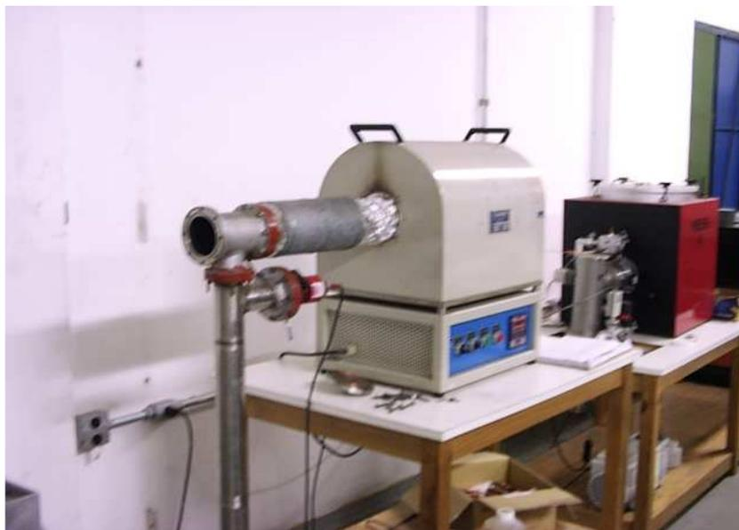
Figura 25. Forno a vácuo utilizado.
