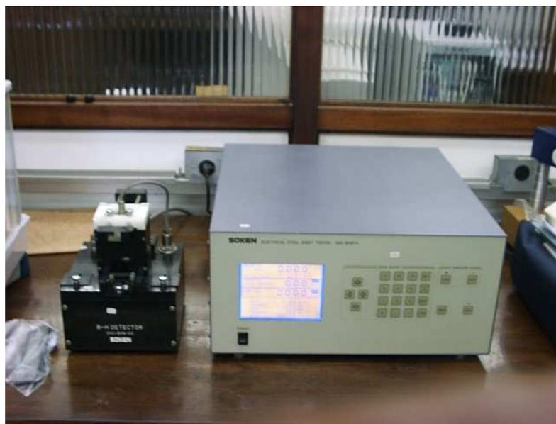
**Figura 16.** Instrumento de medição magnética em uma única lâmina,(“SST” ou “Soken”).
