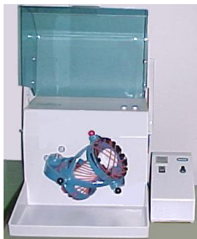
Figura 47. Vista frontal do misturador Turbula utilizado para homogeneização da composição da maioria das pelotas.
