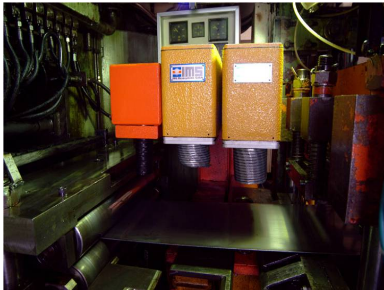
Figura 4.2 – medidor de espessuras através de raios-X.
