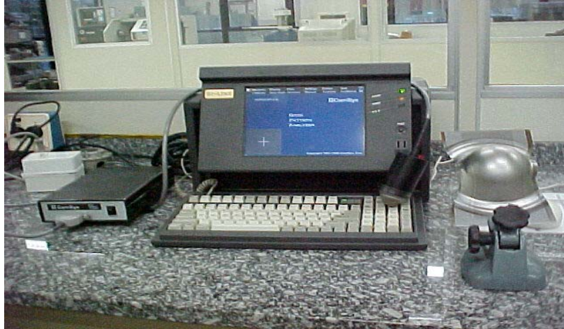
Figura 4.9 – Ilustra o equipamento utilizado para medição das deformações maior e menor na peça-exemplo.
