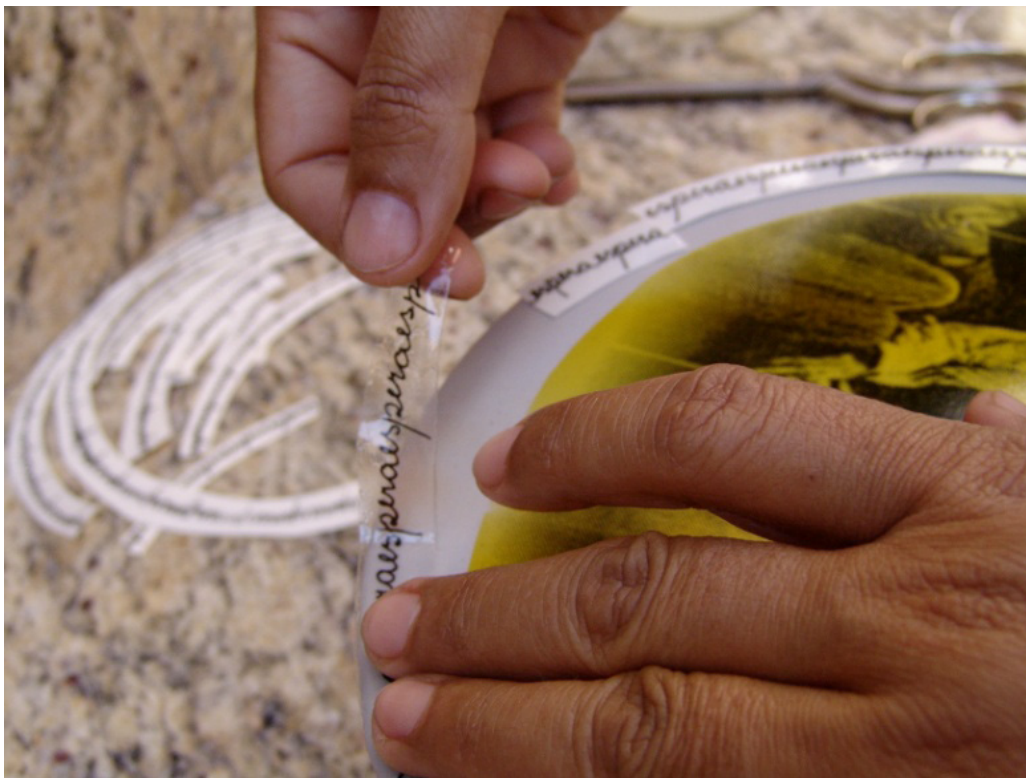
FIGURA 38 – Aplicação do decalque sobre a superfície cerâmica.
