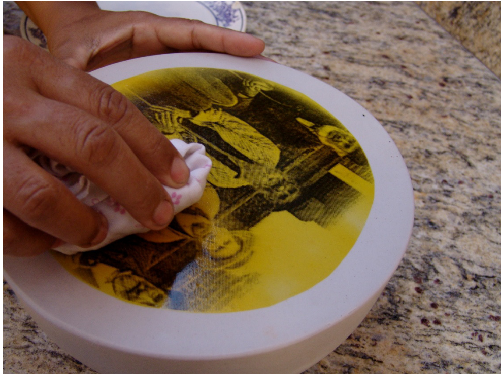
FIGURA 39 – Alisando a superfície do decalque expelindo bolhas e enrugados.
