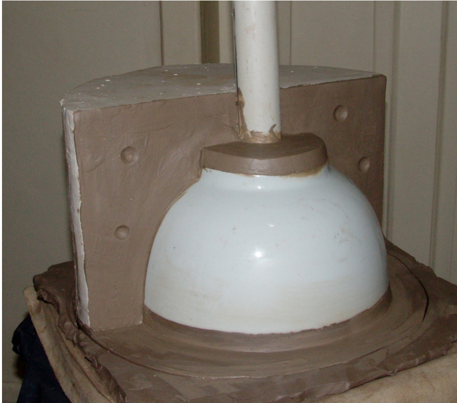
FIGURA 29 – Confeção de forma de gesso para reprodução em barbotina, a partir de uma tigela de porcelana industrializada.
