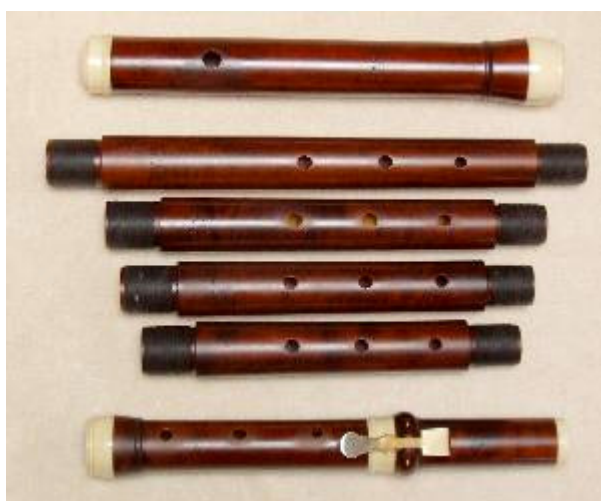
Figura 4 - Flauta Barroca com várias peças da seção central para mudança de diapasão. 15
