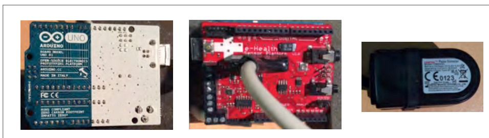
Imagem 35: Placa de Arduino, e-Helath e Pulsimeter, usados durante a pesquisa
