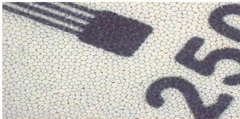
Figura 2 - Ampliação de uma tela e-ink , onde podem ser vistas as partículas que compõem a imagem.
