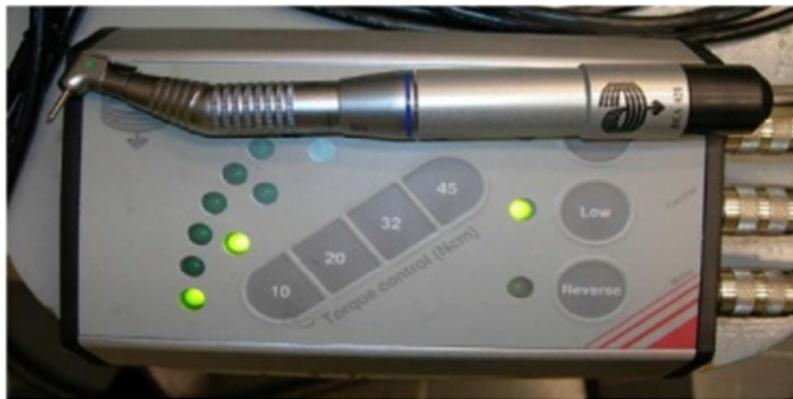
Figura 19 – Torquímetro eletrônico *Nobel Biocare™ Torque Control*
