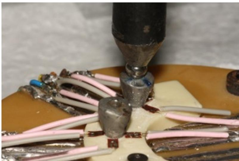
Figura 21 – Aplicação da carga axial estática (300N) nas infraestruturas (Grupo A; Espécime 1)
