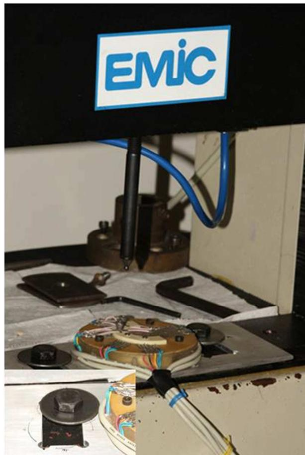
Figura 16 – Experimento posicionado na EMIC para os testes de pré-carga e carga, detalhe do parafuso usado para estabilizar e manter a base na mesma posição durante as repetições dos testes
