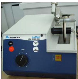
Figura 4.2.1 – Aparelho de corte ISOMET Low Speed Saw (Buehler Ltda, USA)
