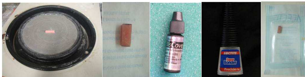
Figura 3: Lixamento dos corpos de prova na politriz. (A) Corpo de prova após lixado com sua superfície rugosa identificada e voltada para cima. (B) Polidor líquido Biscover® (C) Adesivo Super Bonder® (D) Corpo de prova após voltar da esterilização (E)
