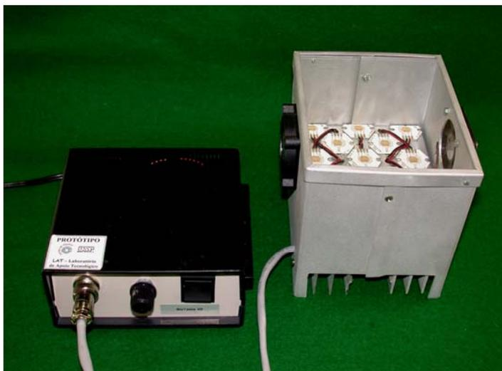
**Figura 2:** dispositivo utilizado no estudo como fonte de luz denominado “Bio Table”
