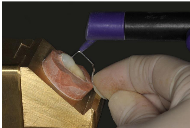
Figura 4.8 – Posicionamento do centro da face lingual do espécime a 5 mm da ponta do microjateador
