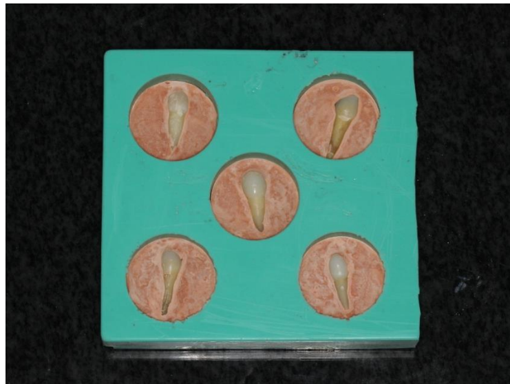
Figura 4.1 – Pré-molares incluídos em uma forma de silicone industrial com gesso especial tipo IV
