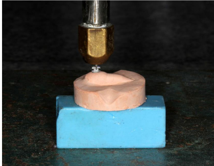
Figura 4.3 – Utilização de uma agulha de Gillmore para padronizar a pressão para a colagem dos braquetes
