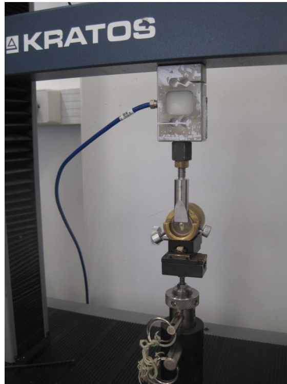
Figura 4.14 – Corpo de prova na máquina de ensaios mecânicos universal Kratos
