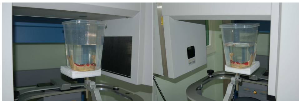
Figura 4.3 - Posicionamento da mandíbula para realização do exame de TCFC. Observar recipiente com água para simular a atenuação de tecidos moles
