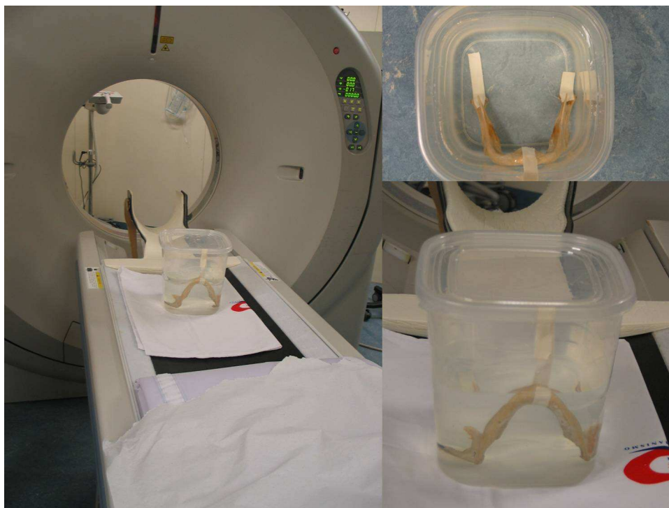
Figura 4.2 - Posicionamento da mandíbula para realização do exame de TCM. Observar recipiente com água para simular a atenuação de tecidos moles
