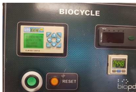
Figura 4.7 – Controlador lógico programável da cicladora mecânica pneumática
