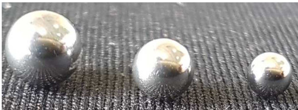
Figura 4.4 - Esferas em inox 420 diâmetro 5, 4 e 3 mm, da esquerda para a direita
