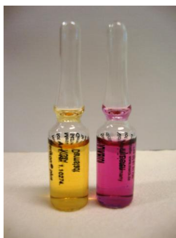
Figura 8 - Controle positivo e negativo do bioindicador Sterikon ® Plus Bioindicador após a esterilização, utilizado no Laboratório de Ecotoxicologia e Parasitologia Ambiental (LEPA), EERP/USP.
