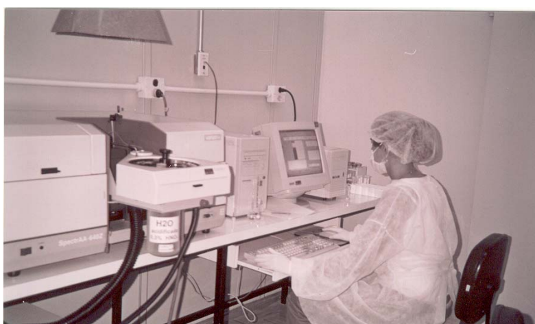
Figura 12. Espectrofotômetro de Absorção Atômica com Gerador de Hidretos (EAA – VGA), Setor de Metais do Laboratório de Pediatria do Hospital das Clínicas da FMRP/USP (Fonte: Oliveira, 2006)
