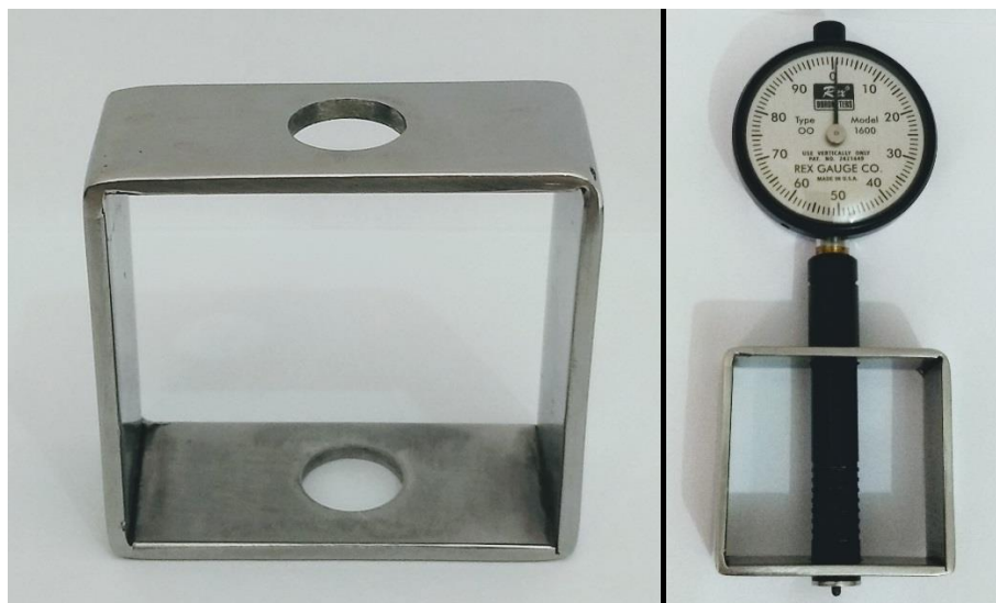
Figura 3 – Dispositivo para auxiliar o equilíbrio do aparelho durômetro
