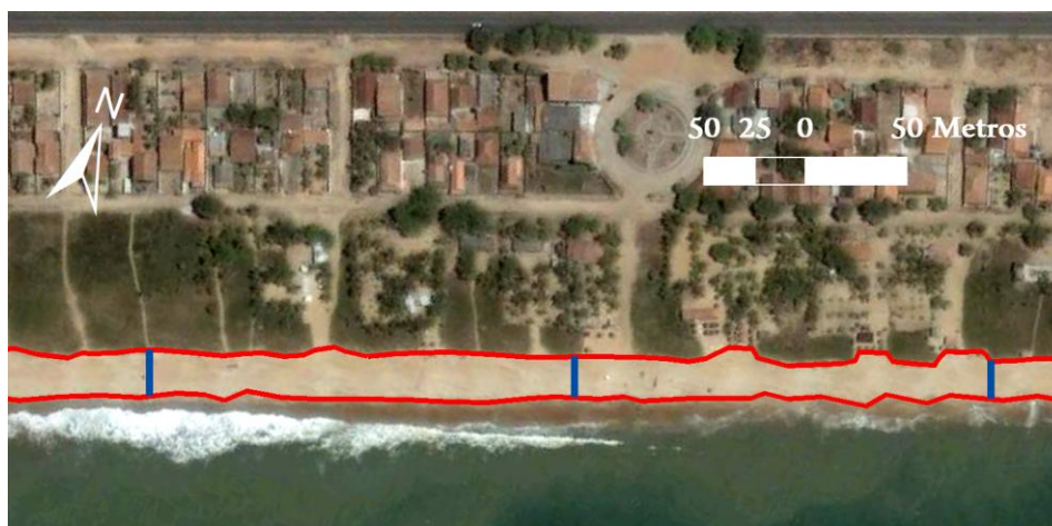
Figura 4: Exemplo da determinação da largura praial em Nova Viçosa (BA). Os traços azuis correspondem aos transectos utilizados para a medição (espaçados em 200 metros, aproximadamente) e a linha vermelha delimita a faixa de praia a ser contabilizada
