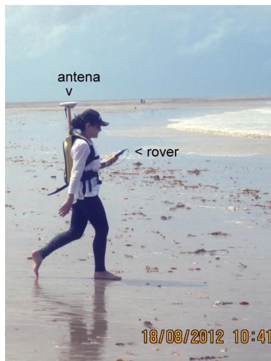
Figura 3: Uso do DGPS em levantamento cinemático, realizado através de caminhada. O receptor do DGPS que está em uma posição desconhecida é chamado de receptor móvel ( rover )
