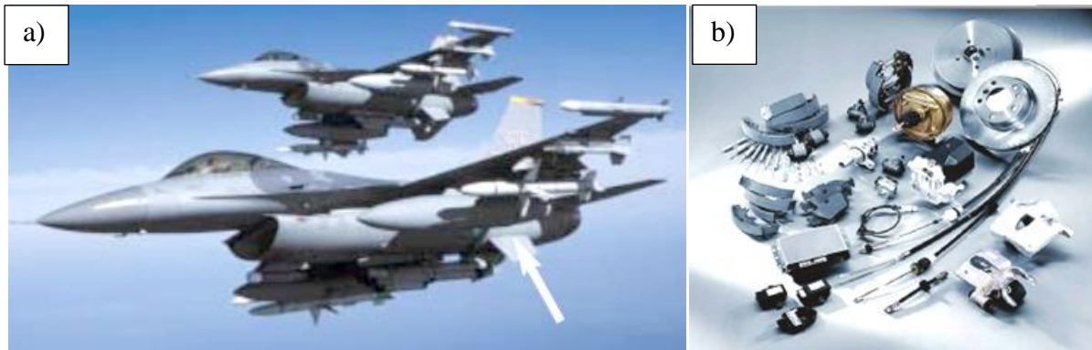
Figura 1 - (a) Substituição de aleta ventral (seta branca) da aeronave militar F-16 originalmente manufaturada em liga de alumínio por CMM da mesma liga (6092) com particulado SiC (HUNT & HERLING, 2004); (b) Aplicação do Al-SiCp na indústria automotiva (STOJANOVIĆ, 2015).
