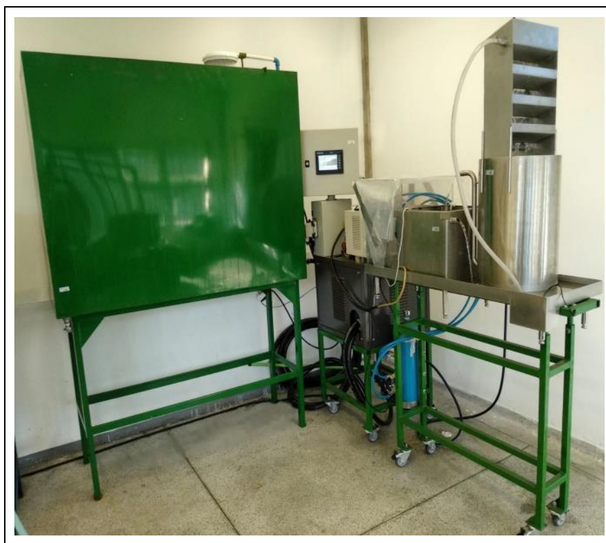
Figura 41: Máquina para ensaio de fadiga térmica do departamento de engenharia de materiais (SMM) da EESC/USP.
