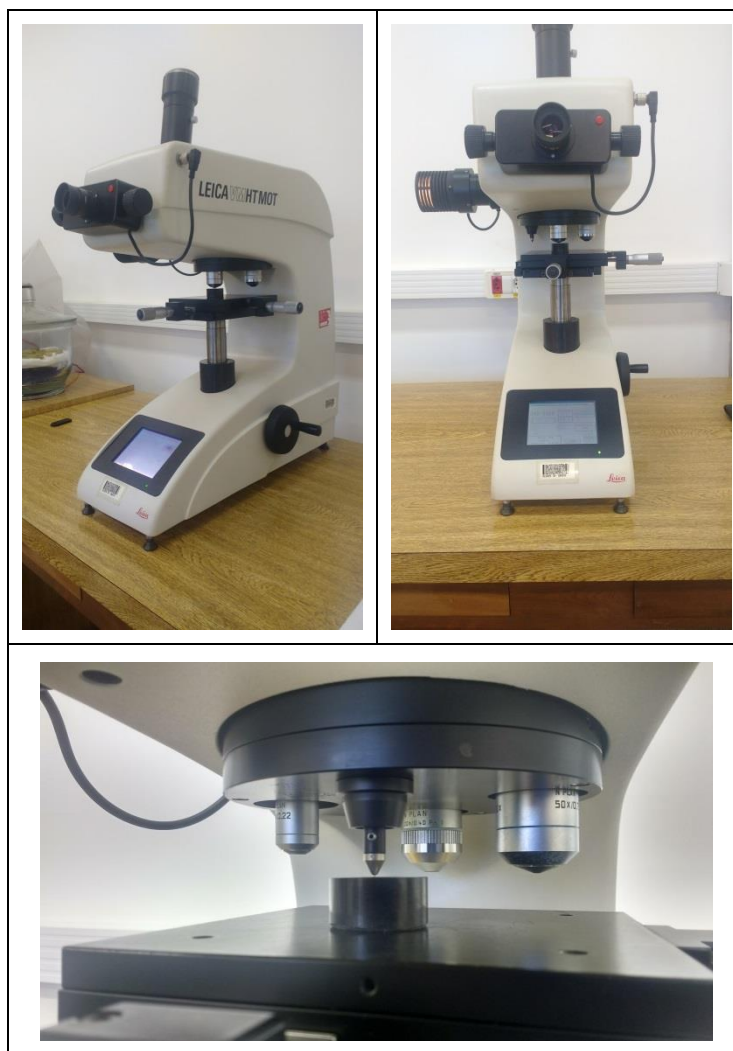
Figura 39: Inspeção de microdureza com microdurômetro marca LEICA®, modelo VMHT MOT, do departamento de engenharia de materiais da EESC/USP.
