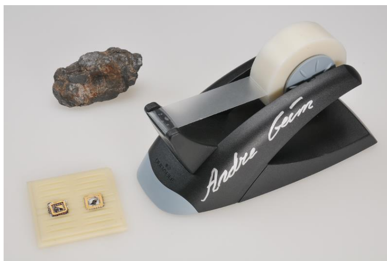
Figura 4.1 – Fragmento de grafite, suporte com fita adesiva e transistores de grafeno doados ao Museu Nobel de Estocolmo (Suécia) por Andre Geim e Konstantin Novoselov.
