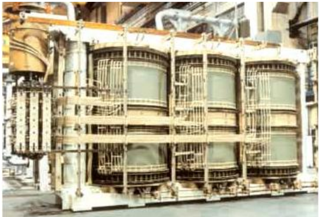
Figura A.1 - Parte ativa montada com o comutador de derivação em carga
