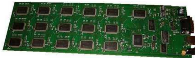
Figura 3.11: Placa Simulação 16 Slaves Profibus DP.
