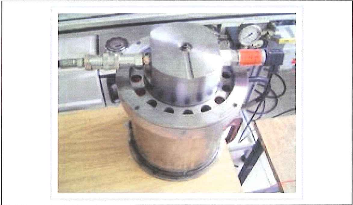
Figura 4.3 – Foto do gerador de transiente de pressão.
