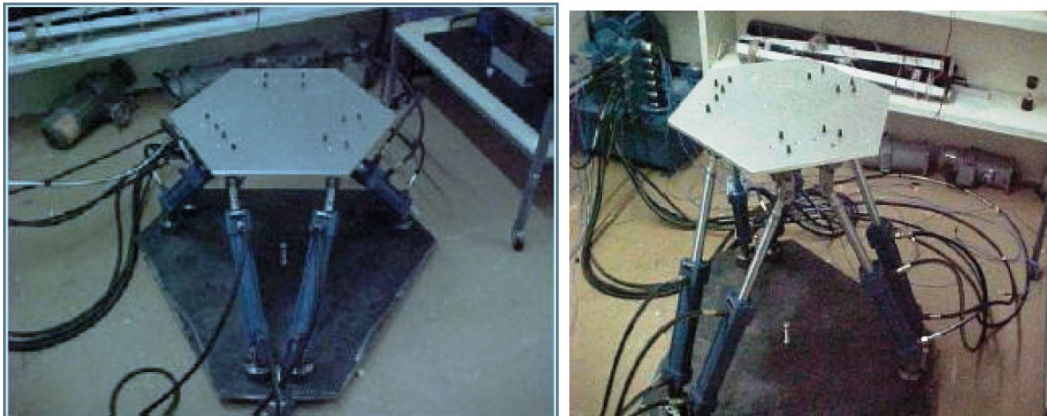
Figura 2.15 Plataforma de Stewart acionada hidraulicamente (MORETTI, 2010).
