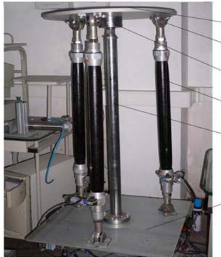
Figura 2.17 Plataforma acionada por músculos pneumáticos (ZHU, 2007).
