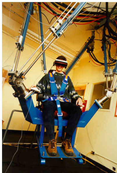
Figura 2.2 Plataforma de Stewart invertida (LI & SALCUDAN, 1997).
