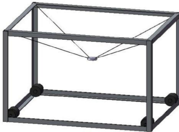
Figura 2.14 Manipulador completo acionado por cabos (TRAVI, 2009).
