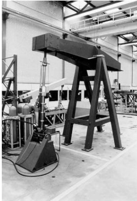
Figura 2.3 Bancada experimental para teste em atuadores hidráulicos (SCHOTHORST, 1997).
