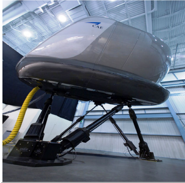
Figura 2.13 Simulador de voo com acionamento elétrico (CAE, 2008).
