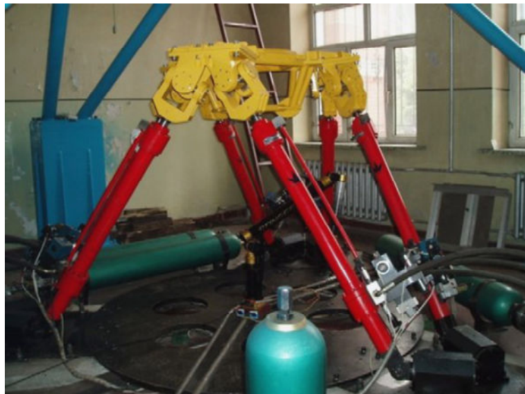
Figura 2.5 Protótipo de um manipulador paralelo com 6 graus de liberdade acionado hidraulicamente (GUO et al, 2008).
