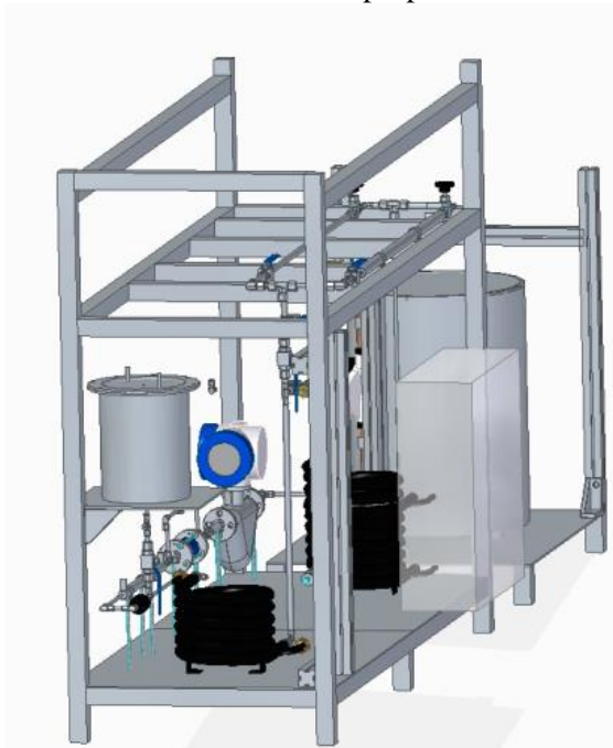
Figura 5.35 – Desenho em CAD da bancada de testes proposta.
