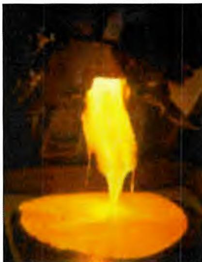
**Figura 17** – Metais e silicatos são vazados na forma líquida pela parte inferior da câmara do conversor<sup>22</sup>
