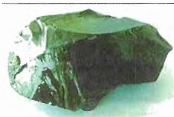
**Figura 18** – Produto virtrificado e inertizado, similar a um mineral vítreo de cor negra e origem vulcânica denominada obsidiana<sup>23</sup>
