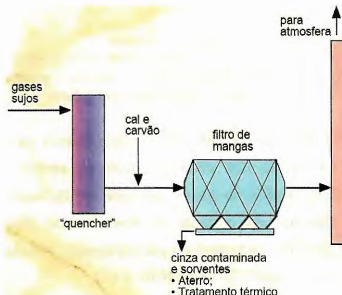
**Figura 6** – Funcionamento de um Sistema de Tratamento de Gases<sup>11</sup>
