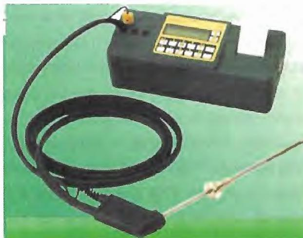
Figura 34 – Analisador de gases de combustão<sup>54</sup>
