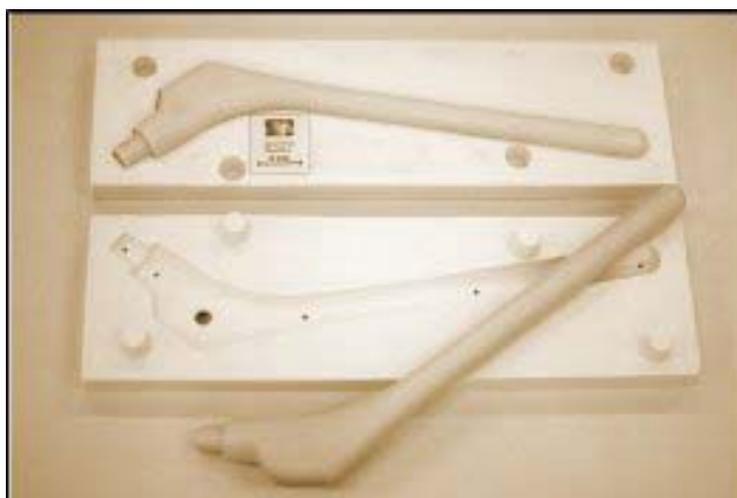
**FIGURA 3.8.2-2** - Peça obtida com molde de silicone no sistema *Vacuum Casting*.
