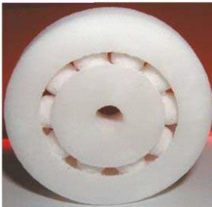
**FIGURA 3.6.8-3** - Peça fabricada no sistema SIS
