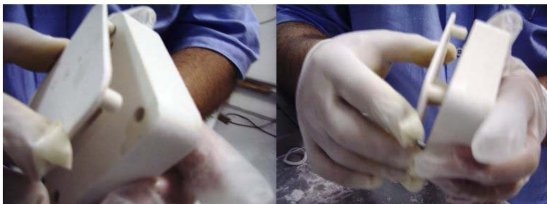
**FIGURA 7.1-13** - Detalhes mostrando que há uma interferência entre pino e furo que impede o encaixe
