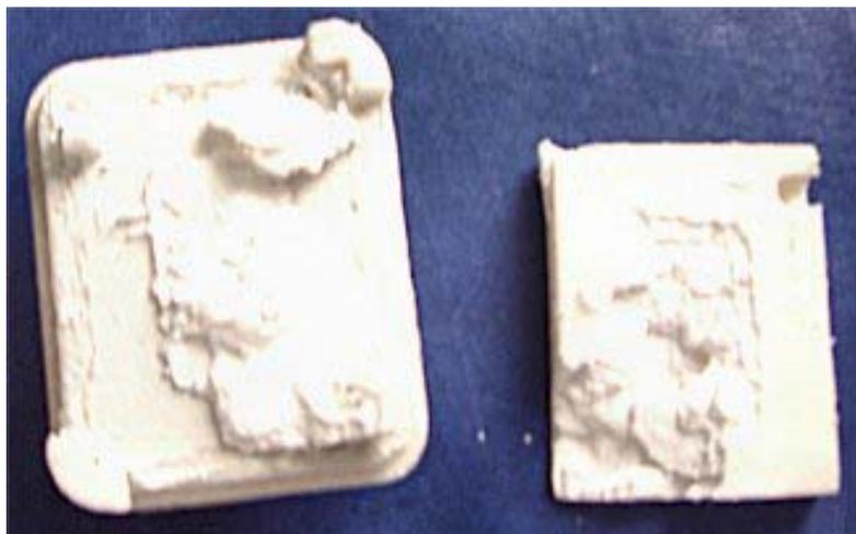
**FIGURA 7.4-3** - Detalhe da quebra do macho do molde 2
