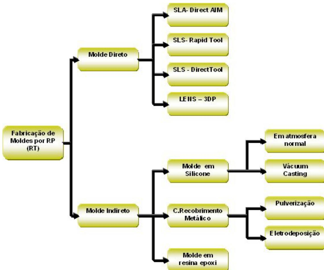
**FIGURA 3.7-1** - Sistemas de fabricação de moldes RT
