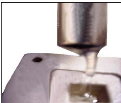
**FIGURA 7.2-1** - Preenchimento da cavidade com resina utilizando seringa
