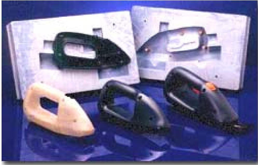
**FIGURA 3.6.9-1** - Ferramental obtido no sistema RT
