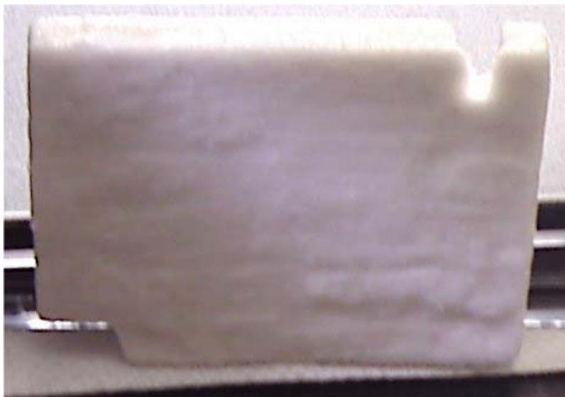
**FIGURA 8.1-2** - Detalhe da superfície irregular do 2º. Macho molde 2.
