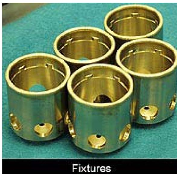
**FIGURA 3.6.6-2** - Peças fabricadas pela tecnologia LENS.
