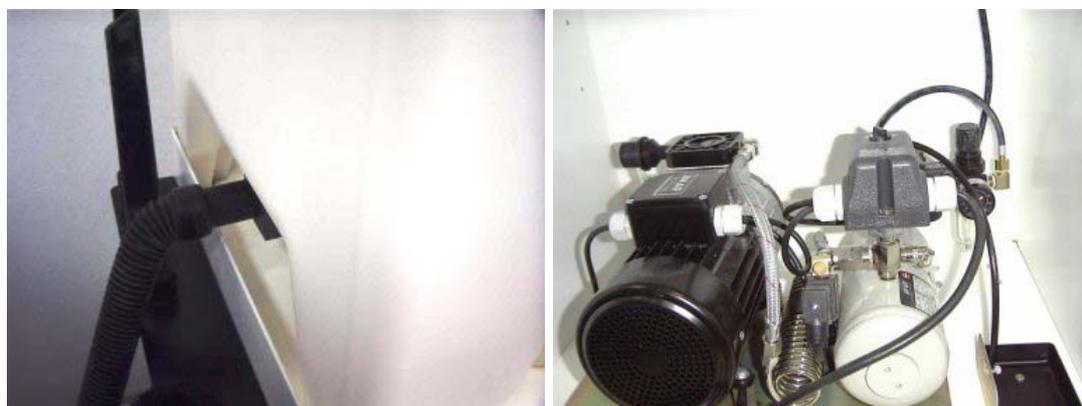
**FIGURA 7.1-9** - À esquerda sistema de exaustão e à direita compressor do sistema de jato de ar
