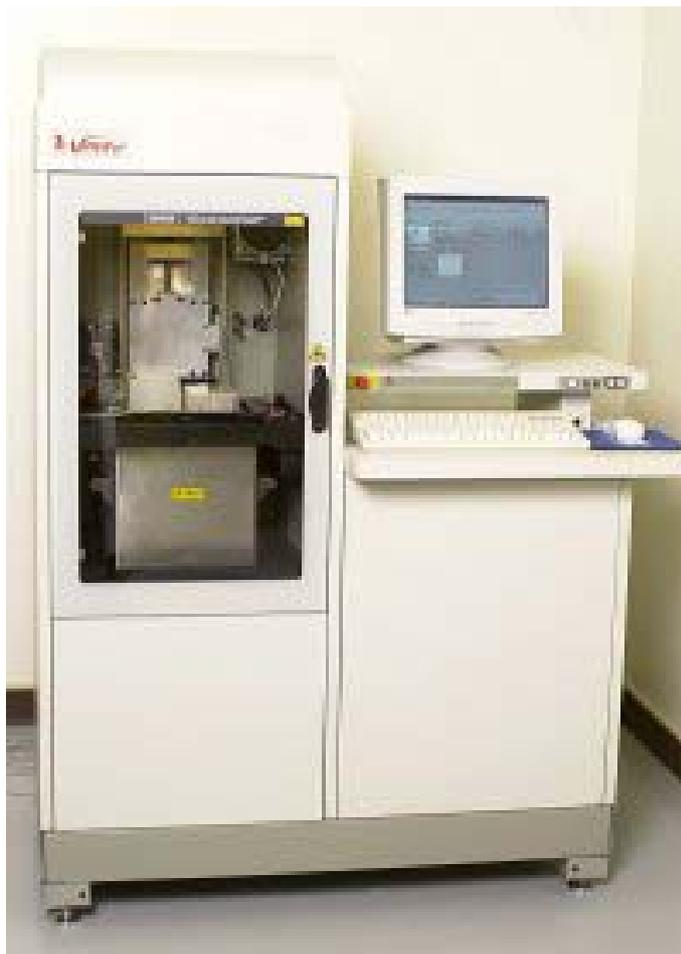
**FIGURA 3.6.1-2** - Máquina de prototipagem SLA
