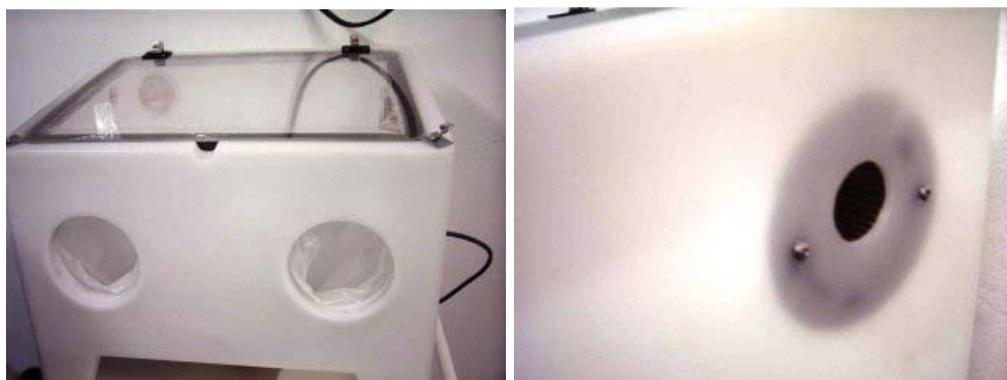
**FIGURA 7.1-8** - Câmara de limpeza das peças prototipadas. À direita detalhe do filtro de entrada de ar
