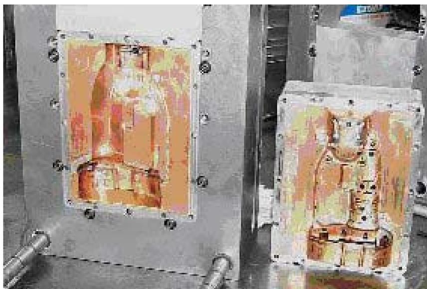
**FIGURA 3.8.4-1** - Molde com inserto de cobre fabricado pelo processo eletrodeposição
