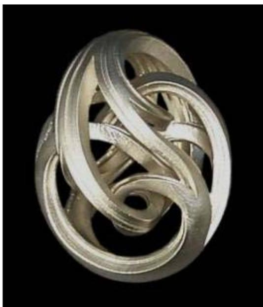
**FIGURA 3.8.4-3** - Modelo construído com Stereolitografia e deposição de cobre, acabamento com sobre camada de níquel
