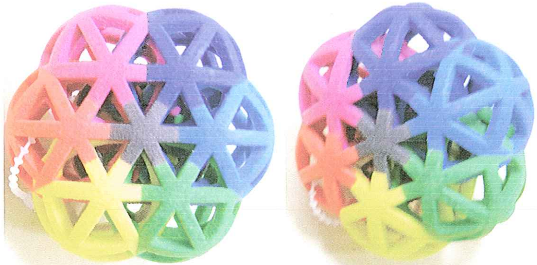
Figura 2.1 – Representação macroestrutural de um scaffold (modelo 3D prototipado da Z Corporation).
