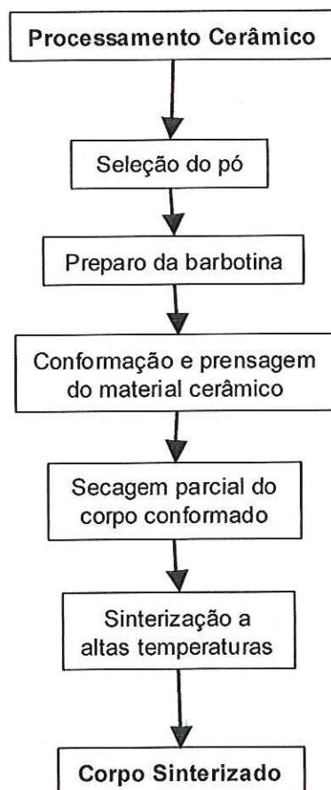
Figura 2.5 – Fluxograma geral de um processamento cerâmico.
