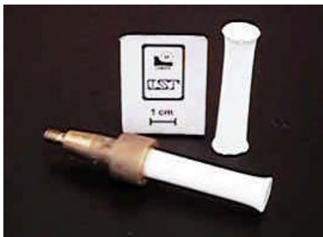
**FIGURA 3.9** - Montagem do tarugo obtido por prensagem isostática no suporte de giro.
