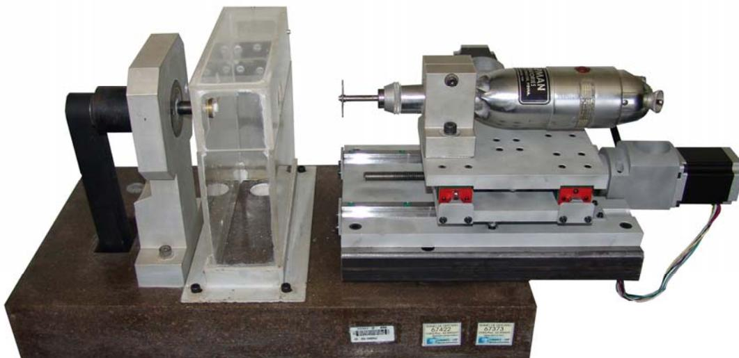
**FIGURA 3.8** - Torno para preparação das amostras.
