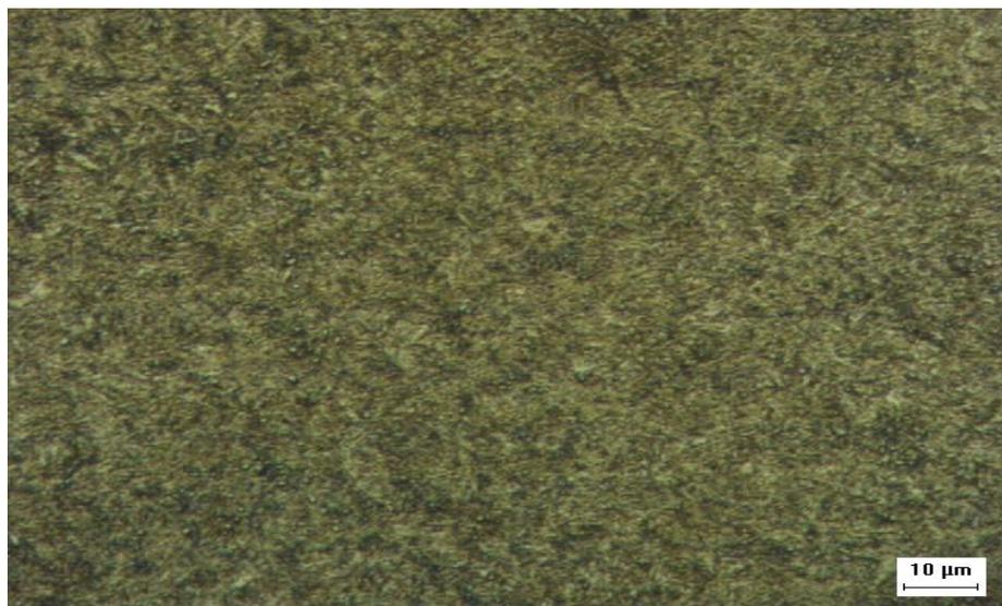
**FIGURA 3.18** - Microestrutura da Peça após o Tratamento (Tempera).
