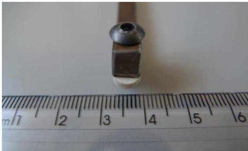
**FIGURA 3.25** - Suporte para ferramenta mono cortante de cerâmica.
