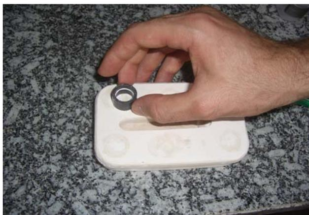
**FIGURA 3.6** - Assentamento dos cilindros plásticos no bloco de gesso.
