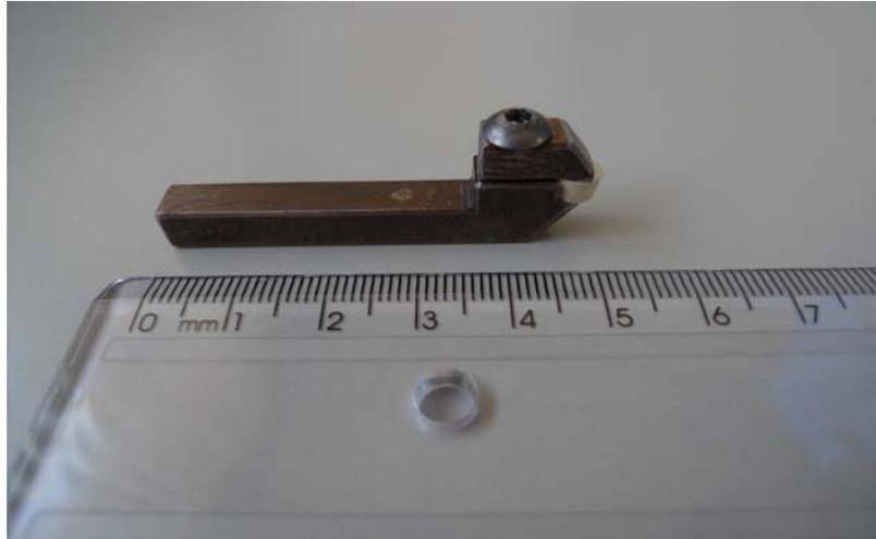
**FIGURA 3.24** - Suporte para ferramenta mono cortante de cerâmica.
