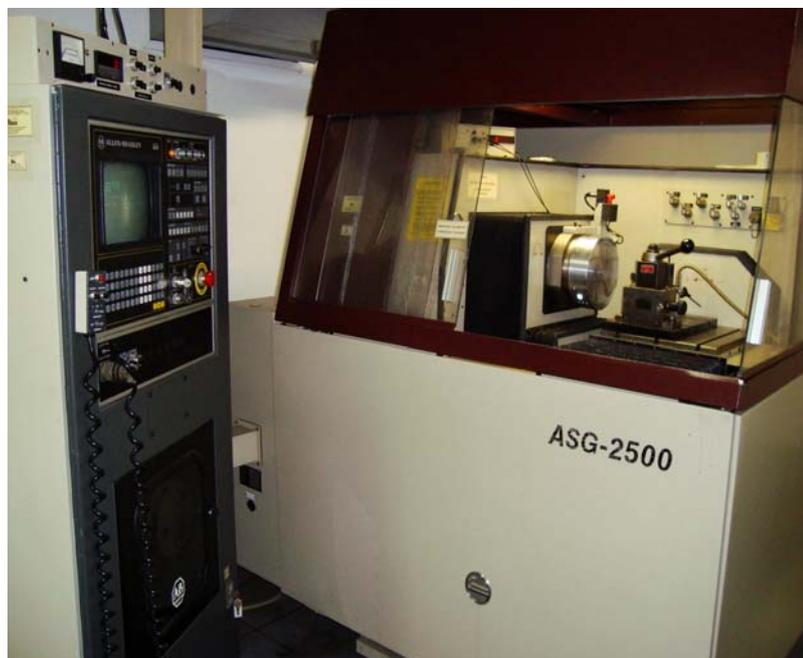
**FIGURA 3.23** - Torno de Ultraprecisão do Laboratório de Engenharia de Precisão da Escola de Engenharia de São Carlos.
