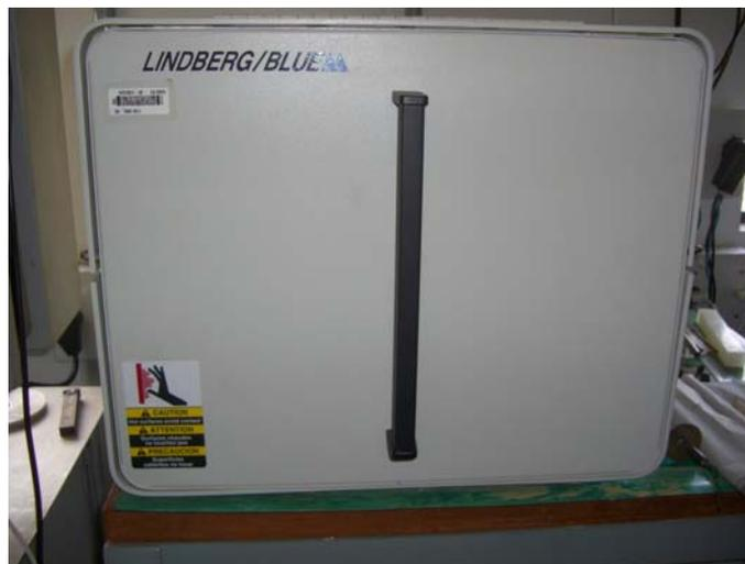
**FIGURA 3.12** - Forno utilizado na sinterização (Vista externa).
