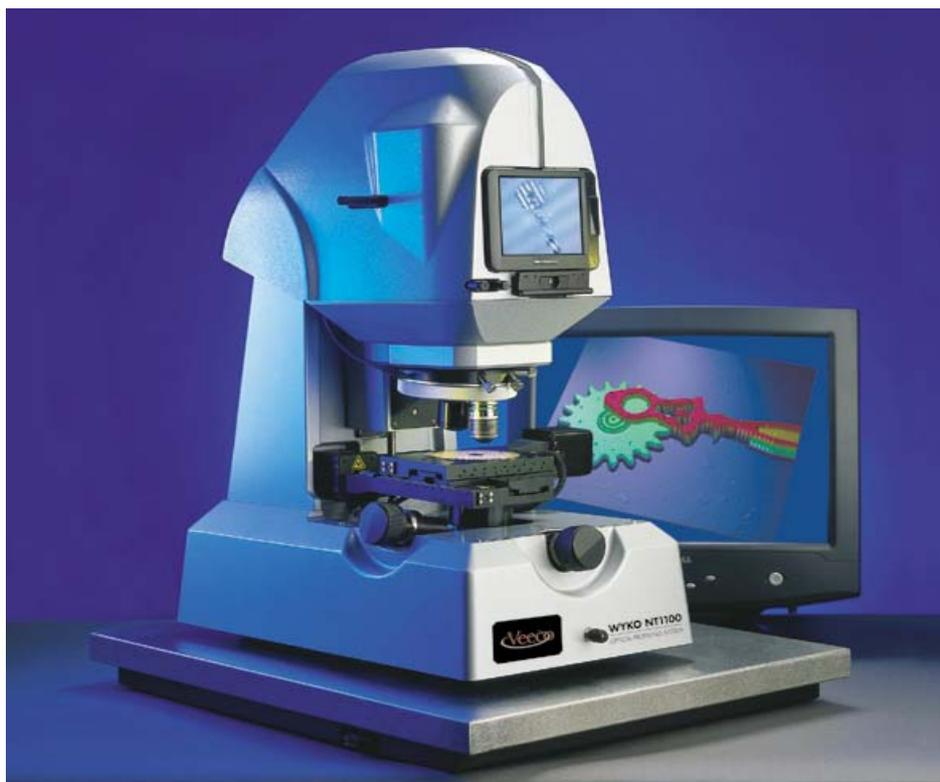
**FIGURA 3.22** - Perfilômetro WYKO – NT1100 do laboratório de engenharia de precisão da Escola de Engenharia de São Carlos.
