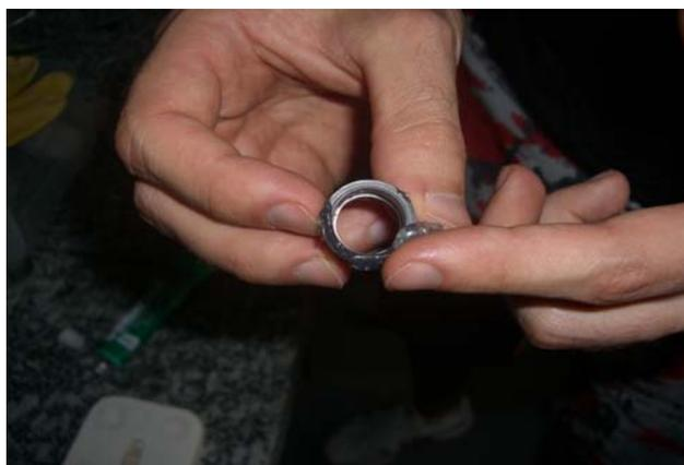
**FIGURA 3.5** - Vedação dos cilindros plásticos com silicone.
