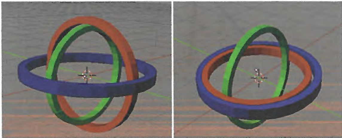
Figura 8 – Representação do Gimbal Lock.
