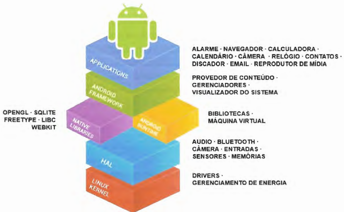
Figura 3 – Estrutura da plataforma Android.
