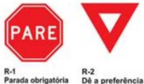
Figura 2.14 – Sinalização de “pare” e “dê a preferência” Fonte: Manual de Sinalização de Trânsito (2007)
