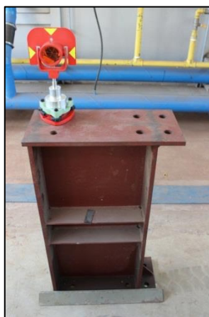
Figura 5 – Base de ferro estrutural
