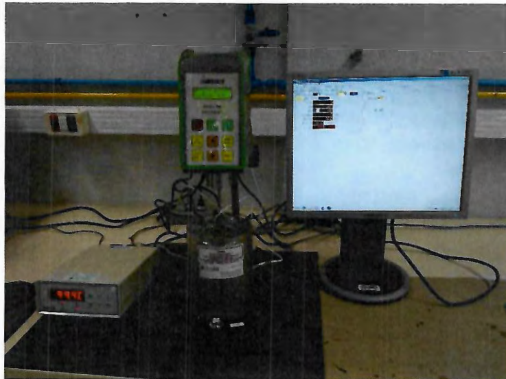
Figura 3 - Equipamento e software para ensaio de Viscosidade Brookfield
