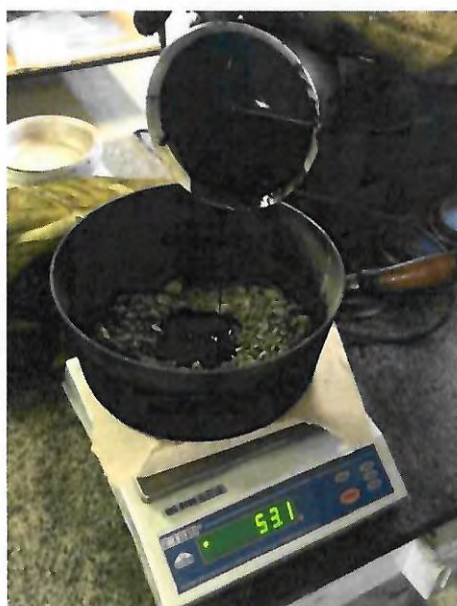
Figura 9 – Usinagem da massa asfáltica
