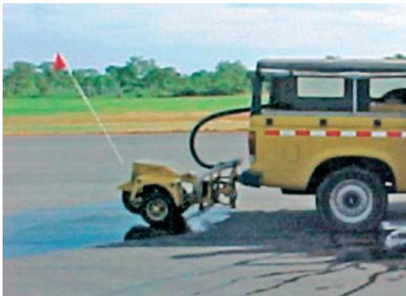
Figura 33 - Exemplo de equipamento de medida de atrito Mu-Meter
