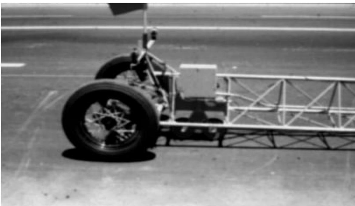
Figura 25 - Perfilômetro CHLOE, utilizado no AASHO Road Test
