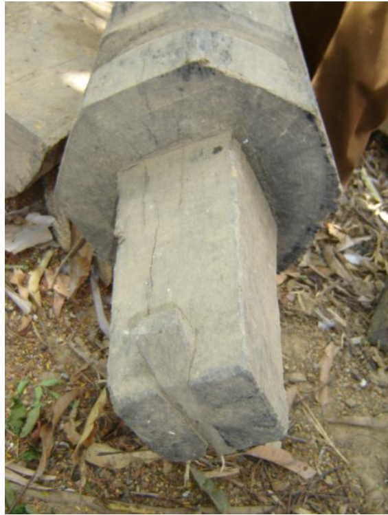
Figura 6. Eixo do carro de boi, terminando em espiga que é atravessada pela cunha .
