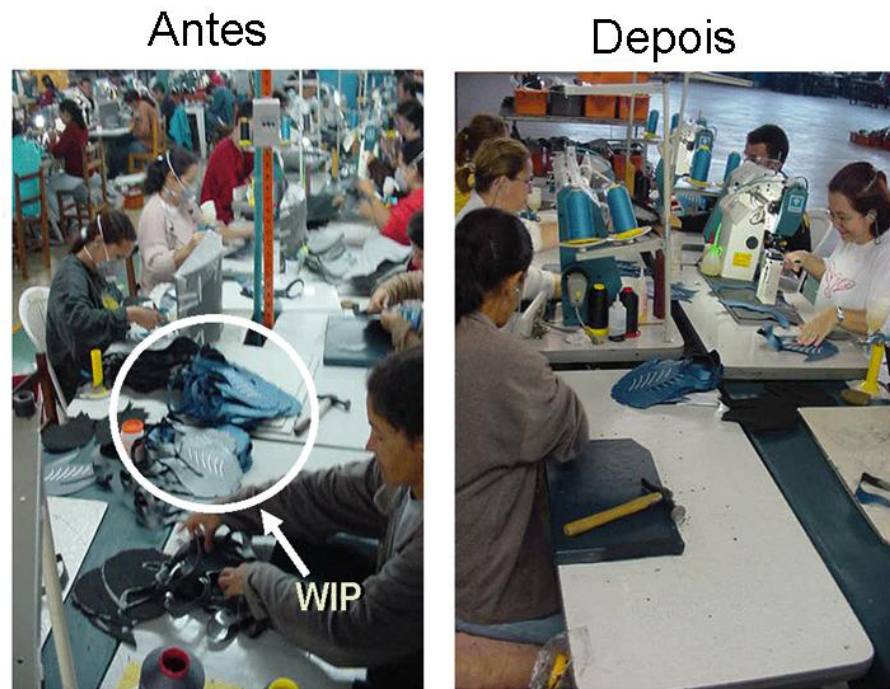
FIGURA 29 - ESTOQUE EM PROCESSO: ANTES E DEPOIS. Fonte: Rentes et al , 2006
