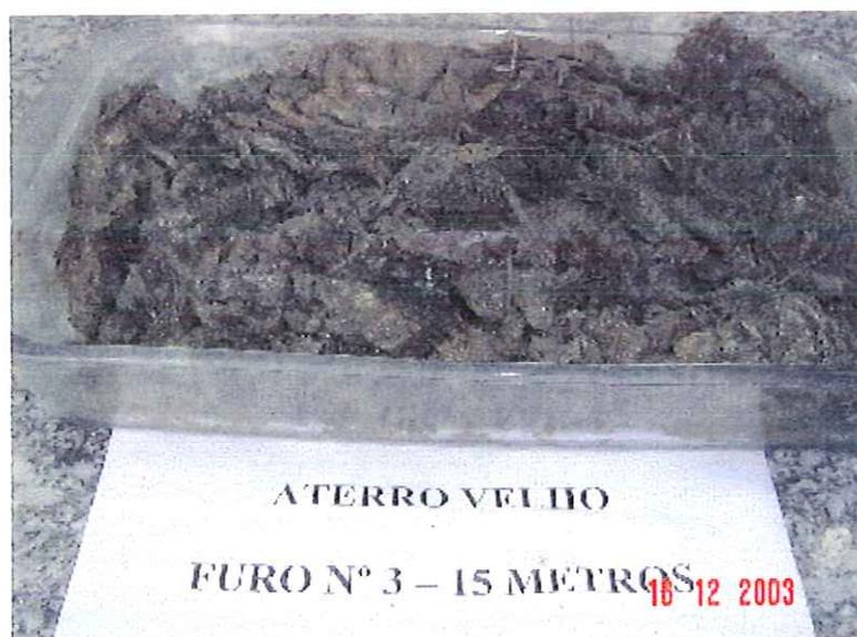
Figura 20 - Amostra coletada no aterro velho sendo preparadas para análise, Coletada no terceiro furo a 15 metros de profundidade.
