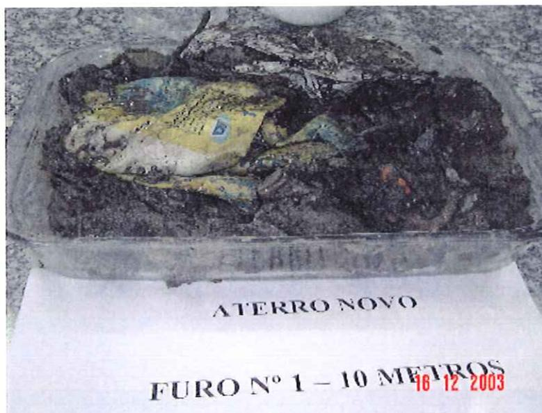
Figura 19 - Amostra coletada no aterro novo, sendo preparada para análise Coletada no primeiro furo a 10 metros de profundidade
