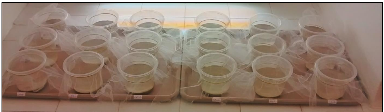
Figura 9: Montagem dos testes de toxicidade aguda com C. sancticaroli .
