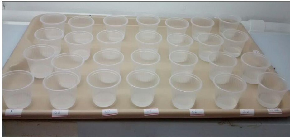
Figura 8: Montagem dos testes de toxicidade aguda com C. dubia e D. similis .
