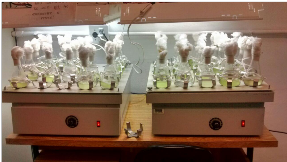
Figura 7: Amostras de P. subcapitata em teste sob iluminação e agitação controladas e constantes.
